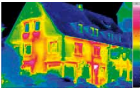
OBR. 64: Ilustračný príklad termovíznej diagnostiky domu; ZDROJ: [305]
