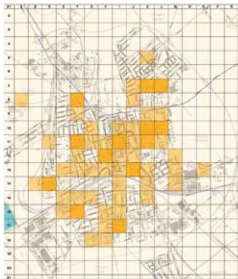
OBR. 9: Tepelná priepustnosť obytných budov
